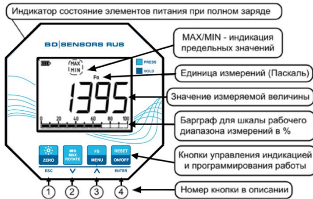
Рисунок А. Элементы лицевой панели прибора
