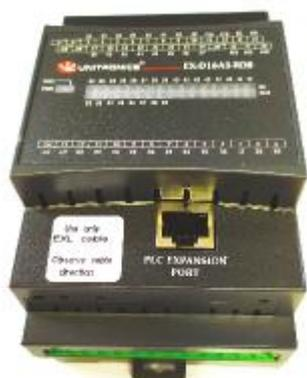
Рисунок 6 - Общий вид модуля расширения EXD16-xxxx
