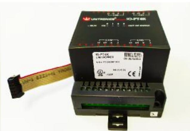
Рисунок 9 - Общий вид модуля расширения IO-PT-xxxx
