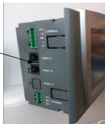
Рисунок 5 - Общие виды контроллера модификации V570-xxxxxx
