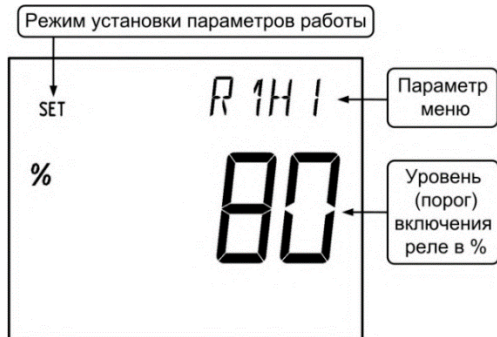
Рисунок В. Назначение отображаемых элементов дисплея в режиме настройки (программирования) параметров работы (R1H1 – установка уровня сигнала для включения контактов SW1 реле)
