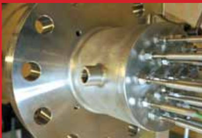
Компрессионные фитинги для герметизации верхней части камеры безопасности
