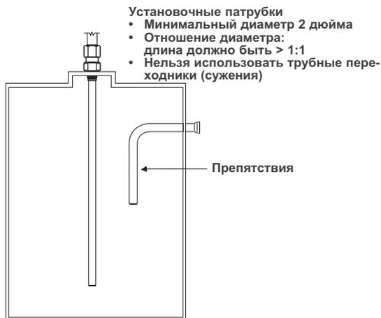
В связи с тем, что внешняя трубка коаксиального зонда заземлена, расположенные рядом объекты не воздействуют на зонд, поэтому влияние патрубков отсутствует. Отражения, возникающие вдоль длины зонда, являются ожидаемыми. Таковыми являются опорный сигнал и сигнал, отраженный от технологической среды.
