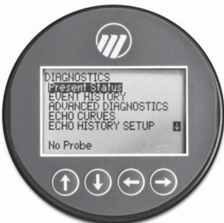
ECHO HISTORY SETUP (НАСТРОЙКА. ИСТОРИИ СИГНАЛА) – Модель 706 обладает уникальной функцией, которая позволяет автоматически фиксировать графические формы отраженных сигналов, основываясь на диагностических событиях, времени возникновения или их комбинации. В данном пункте меню содержатся параметры, которые позволяют произвести настройку этой функции.
