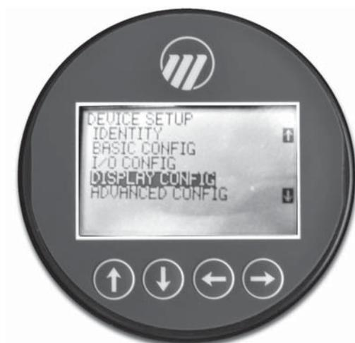
Прокрутить вниз до пункта Probe Buildup (Налипания на зонде) и нажать кнопку Ввод, после чего выбрать пункт View (Просмотр). На главном экране будет отображаться процентное содержание налипаний.
