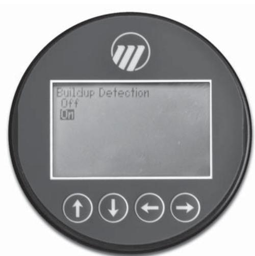
Информацию о налипаниях можно проверить на главном экране дисплея. Сначала необходимо перевести устройство в режим отображения процентного содержания налипаний. В главном меню выбрать DEVICE SETUP (НАСТРОЙКА) и нажать кнопку Ввод.
