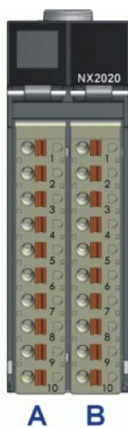
Изображение 2: Разводка выводов разъема
