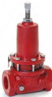
Клапан открывается под давлением и функционирует в дроссельном или отсечном режиме там, где входное давление не превышает 2,8 бар.
