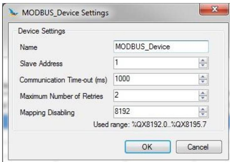
Рисунок 55: Конфигурация устройств
