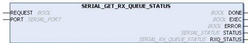
Рисунок 114: Блок, используемый для визуализации состояния очереди RX
