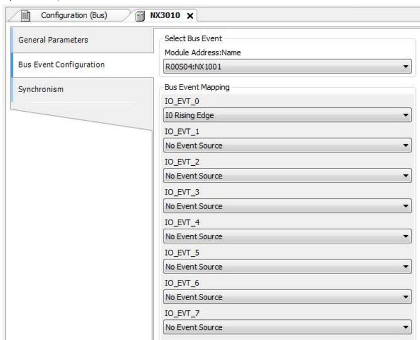
Рисунок 46: Экран конфигурации для внешнего события на центральном процессоре (ЦП)
