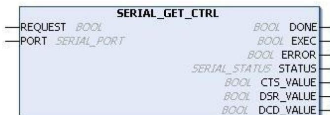
Рисунок 113: Блок, используемый для визуализации управляющих сигналов
