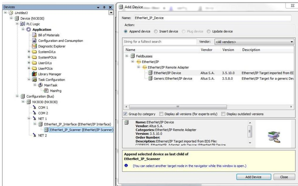
Рисунок 92: Добавление адаптера EtherNet/IP под сканером
