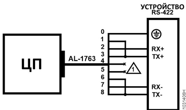
Рисунок 13: Схема подключений RS-422 с терминированием
