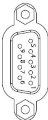
Рисунок 7: Разъем типа мама (с внутренней резьбой) DB9
