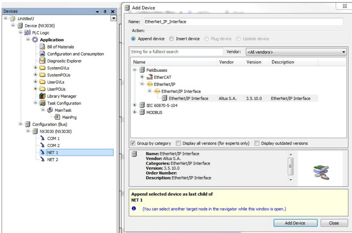
Рисунок 90: Добавление интерфейса EtherNet/IP
