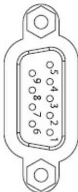
Рисунок 8: Разъем типа мама (с внутренней резьбой) DB9
