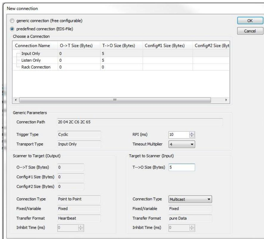
Рисунок 95: Окно новых подключений EtherNet/IP
