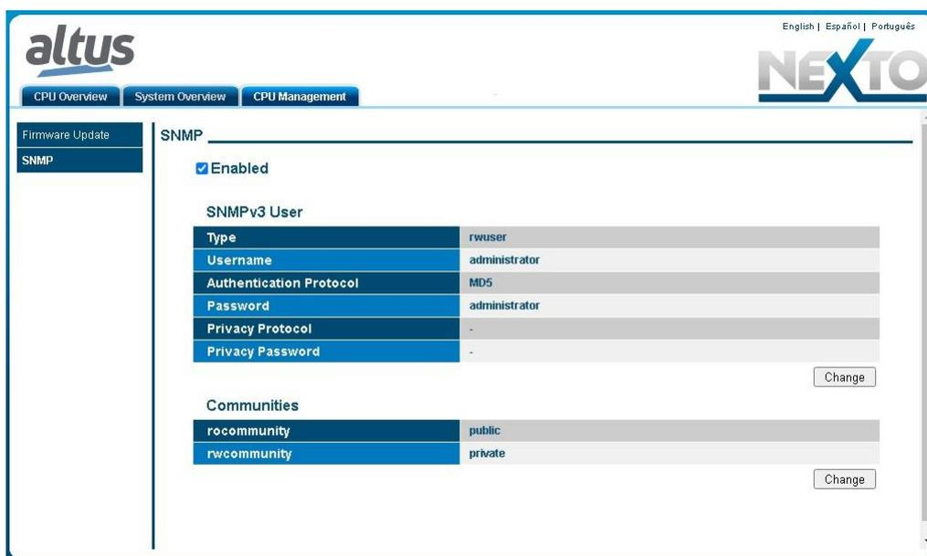
Рисунок 132: Экран конфигурации состояния SNMP
