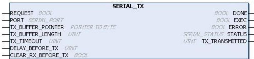
Рисунок 119: Блок для передачи значений по последовательному интерфейсу
