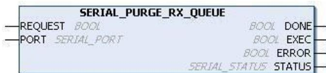
Рисунок 115: Блок, используемый для очистки очереди RX
