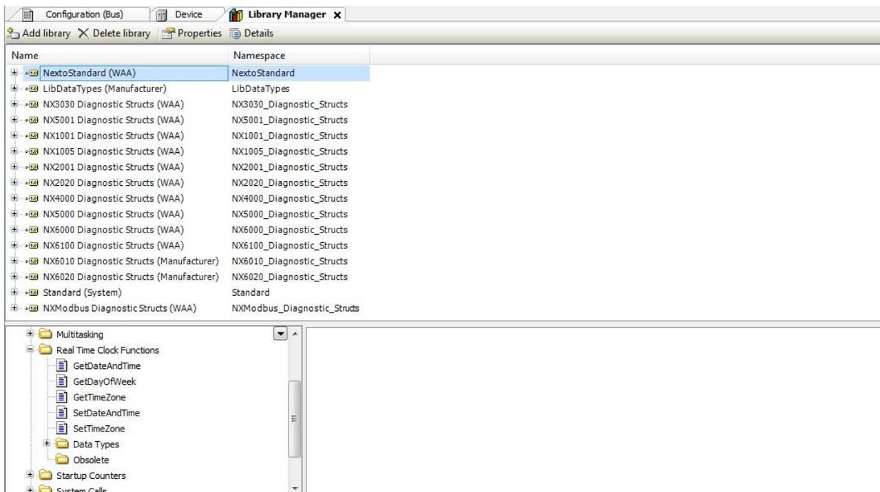
Рисунок 99: Блоки для считывания и записи часов
