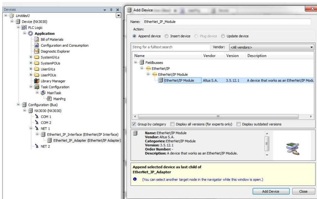
Рисунок 97: Добавление модуля EtherNet/IP под адаптер
