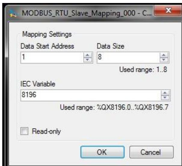
Рисунок 63: Конфигурирование отношения протокола MODBUS
