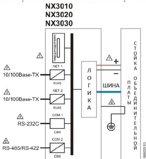
Рисунок 5: Электрическая схема центральных процессоров NX3010, NX3020 и NX3030
