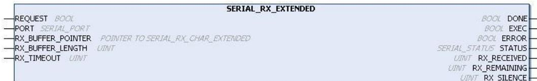
Рисунок 117: Блок, используемый для считывания приемного буфера
