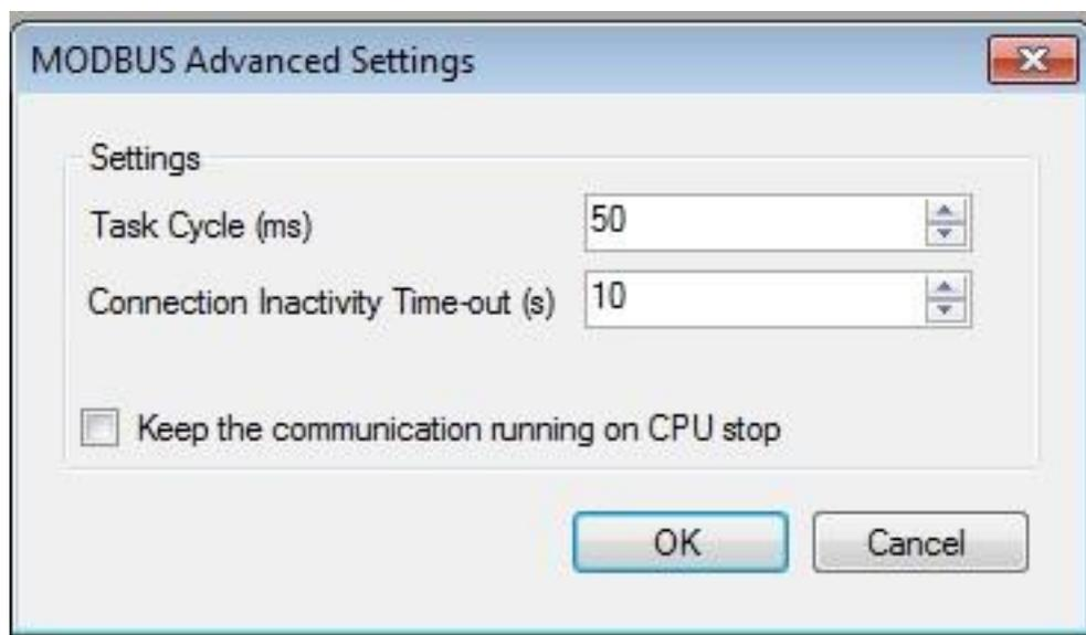
Рисунок 74: Экран конфигурации дополнительных настроек сервера MODBUS
