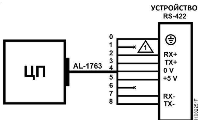
Рисунок 14: Схема подключений RS-422 с внешним терминированием
