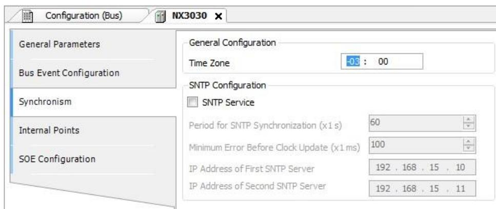
Рисунок 49: Конфигурация простого протокола сетевого времени (SNTP)
