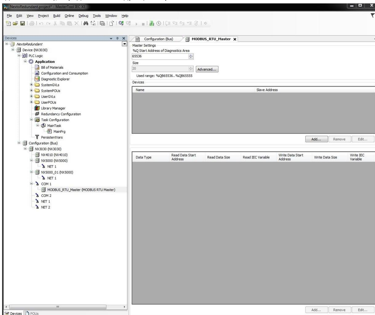
Рисунок 54: Экран настройки ведущего устройства MODBUS RTU
