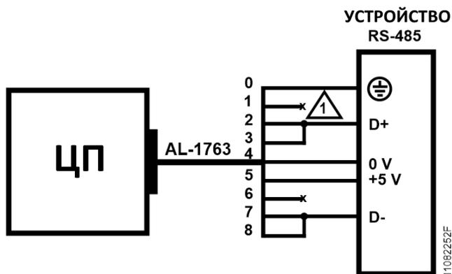
Рисунок 11: Схема подключений RS-485 с внешним терминированием
