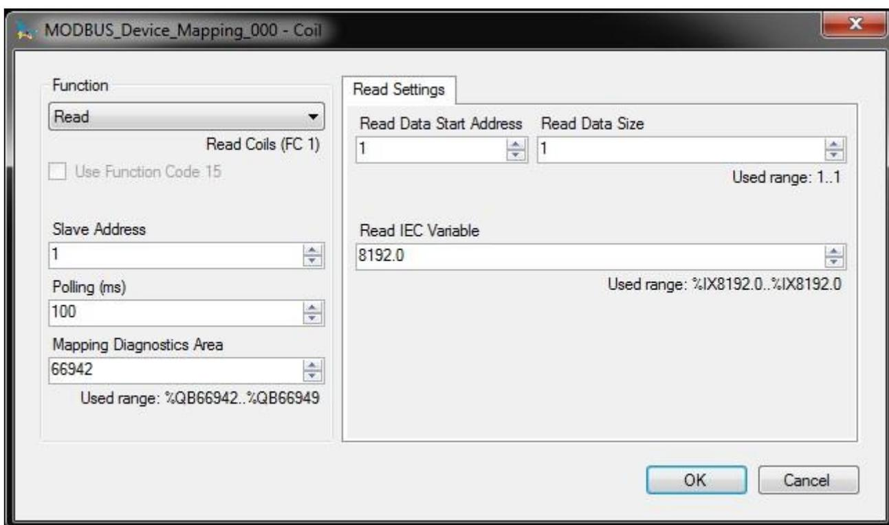
Рисунок 72: Функция протокола MODBUS
