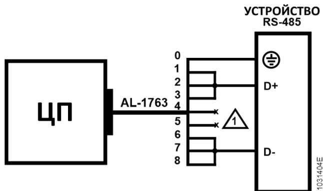
Рисунок 10: Схема подключений RS-485 с внутренним терминированием
