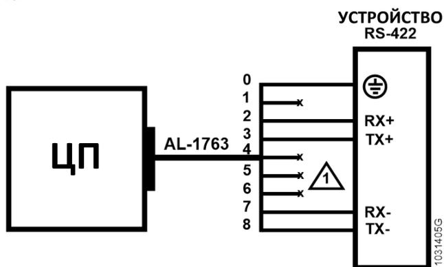
Рисунок 12: Схема подключений без терминирования
