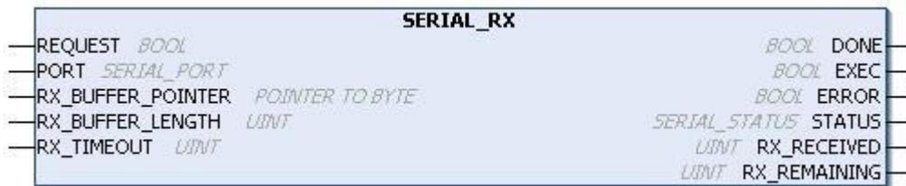
Рисунок 116: Блок, используемый для считывания значений приемного буфера
