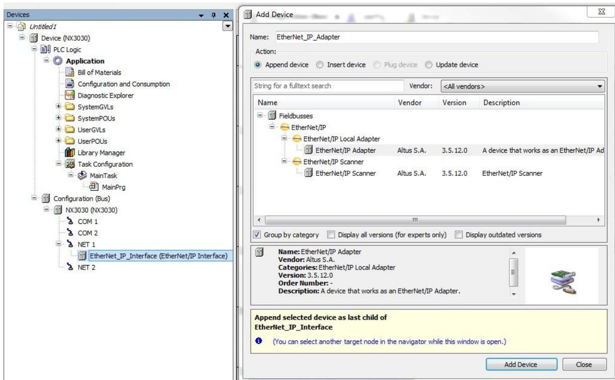
Рисунок 91: Добавление адаптера или сканера EtherNet/IP
