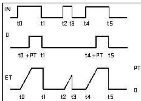
Рисунок 125: Графическое представление логики работы блока TON\_RET
