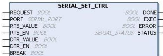
Рисунок 118: Блок для записи управляющих сигналов
