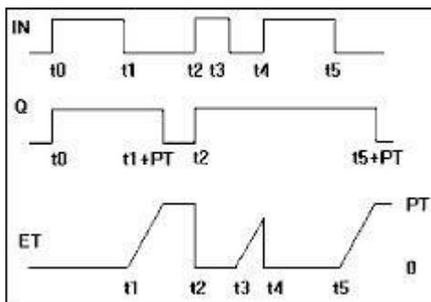
Рисунок 123: Графическое представление логики работы блока TOF\_RET
