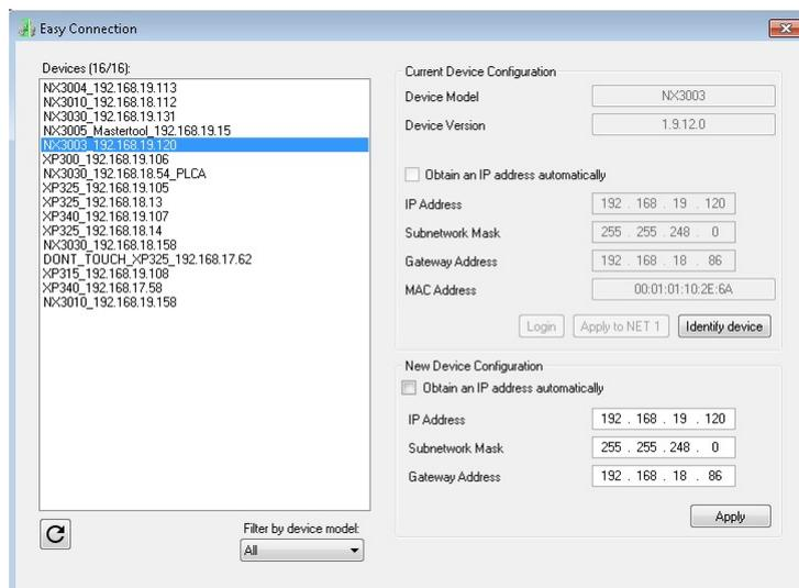
Рисунок 26: Простое подключение
