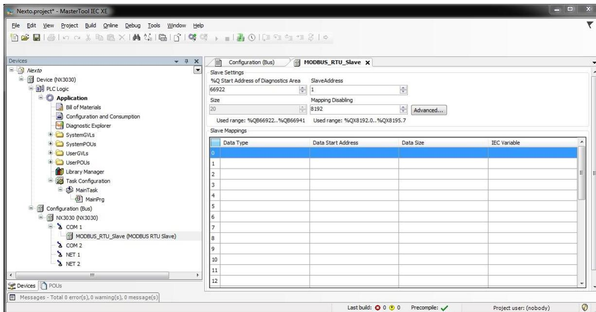
Рисунок 61: Экран конфигурации ведомого устройства MODBUS RTU
