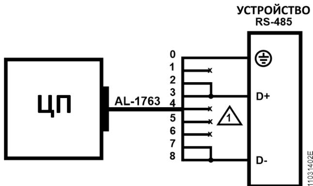
Рисунок 9: Схема подключений RS-485 без терминирования
