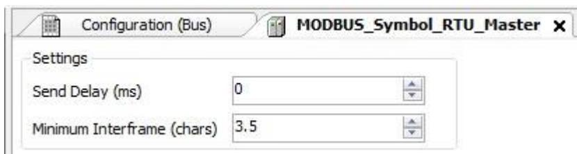
Рисунок 50: Экран конфигурации ведущего устройства MODBUS RTU
