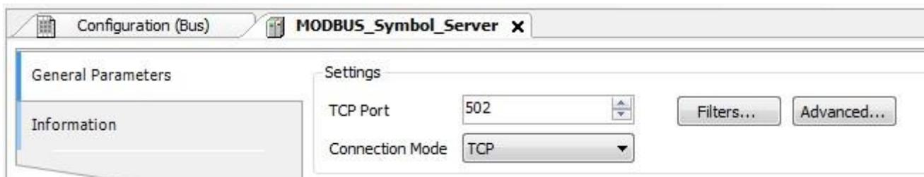
Рисунок 73: Экран конфигурации общих параметров сервера MODBUS
