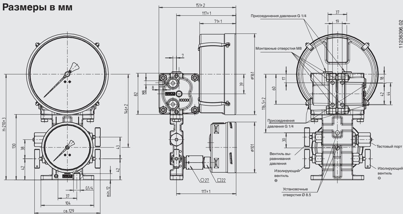
Чертеж с установленным адаптером (межосевое расстояние 54 мм)
