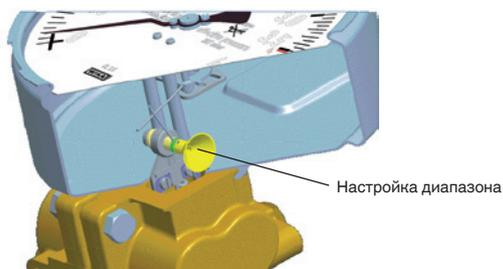
Устройство настройки расположено на "4 часах" на периметре корпуса, доступ к нему возможен после снятия крышки. При приложенном к прибору номинальном давлении вставьте отвертку (размером 3 мм) в направляющее отверстие и установите стрелку на конечное значение диапазона, поворачивая ее по часовой стрелке (для уменьшения измерительного
