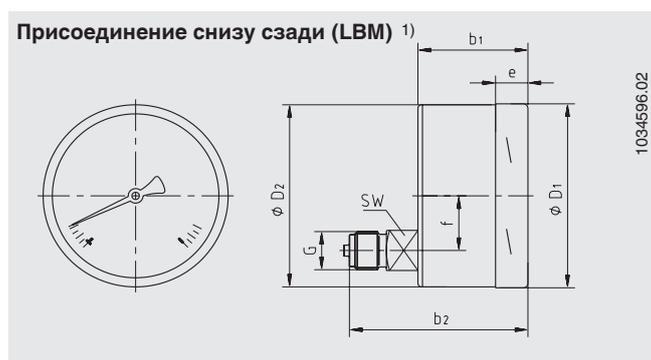
1) Положение присоединения – сзади только для манометров NS 63 и 100 без гидрозаполнения
